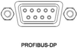
图中标有“Profibus-DP”的接口，支持接驳标准 Profibus-DP 连接器。详情参阅本手册6.7 章节。
