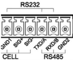
串行通讯接口采用RS232C（标准产品）和RS485 接口（输出格式与RS232C 相同）。本仪表设计的RS232 和 RS485 接口端子复用，通过标定开关旁的（232）/（485）拨动开关进行二选一使用。
