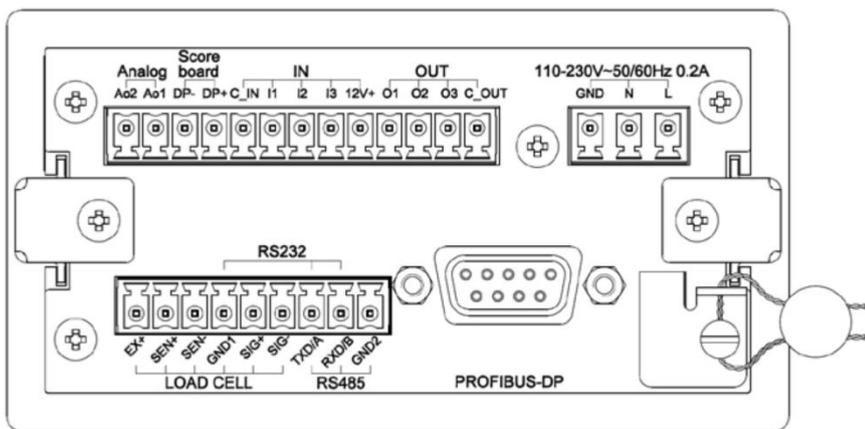
图3-2 仪表后面板接口及铅封示意图
