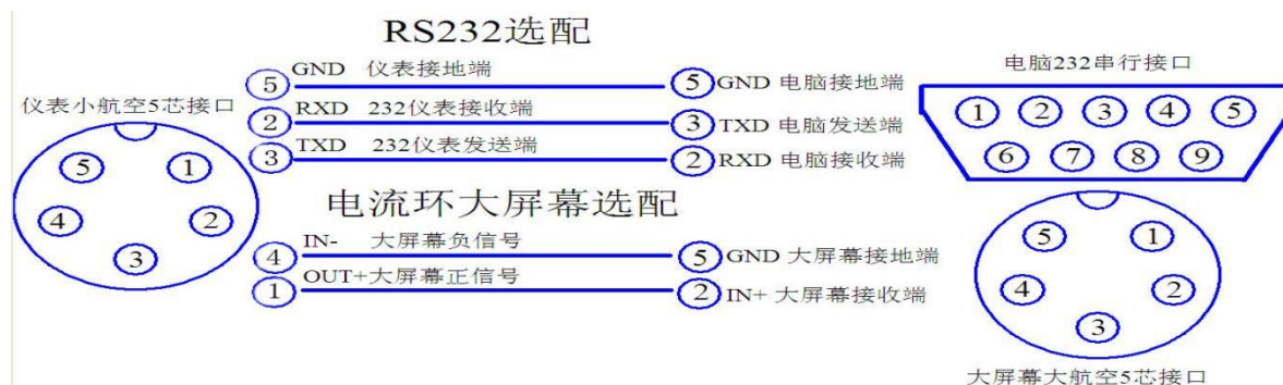
(图 2-6) RS232 和电流环接口定义
